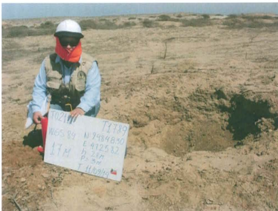
Fotografía N° 1. El pozo T1789 no se ubicó a nivel superficial posiblemente se encuentra enterrado, dentro de una excavación de sección cuadrada a 1,5m de profundidad.
