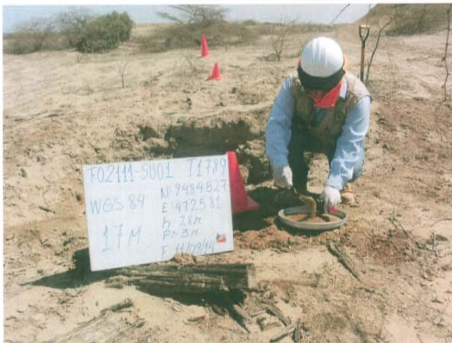
Fotografía N° 3. Toma de muestra de suelo sobre los montículos Alrededores de la posible ubicación del pozo, se aprecian restos de Maderas de antiguos soportes para la extracción del petróleo.
