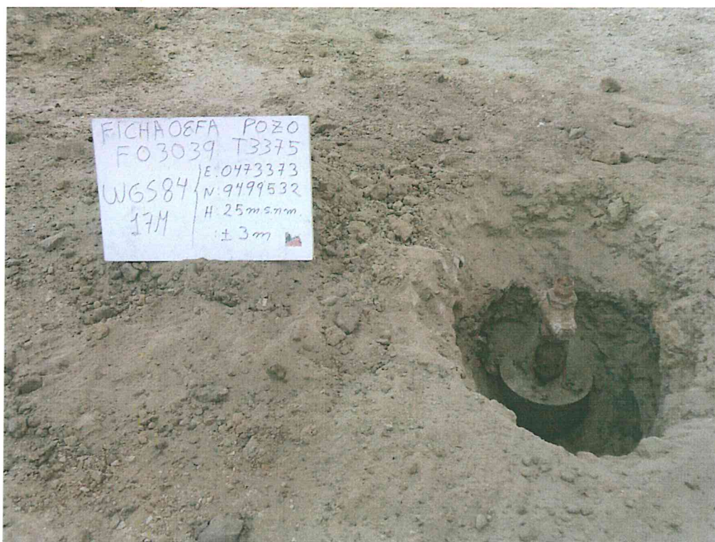
Fotografía N° 1. Identificación del pozo inactivo con código PERUPETRO T3375. Presenta casing corroído.
