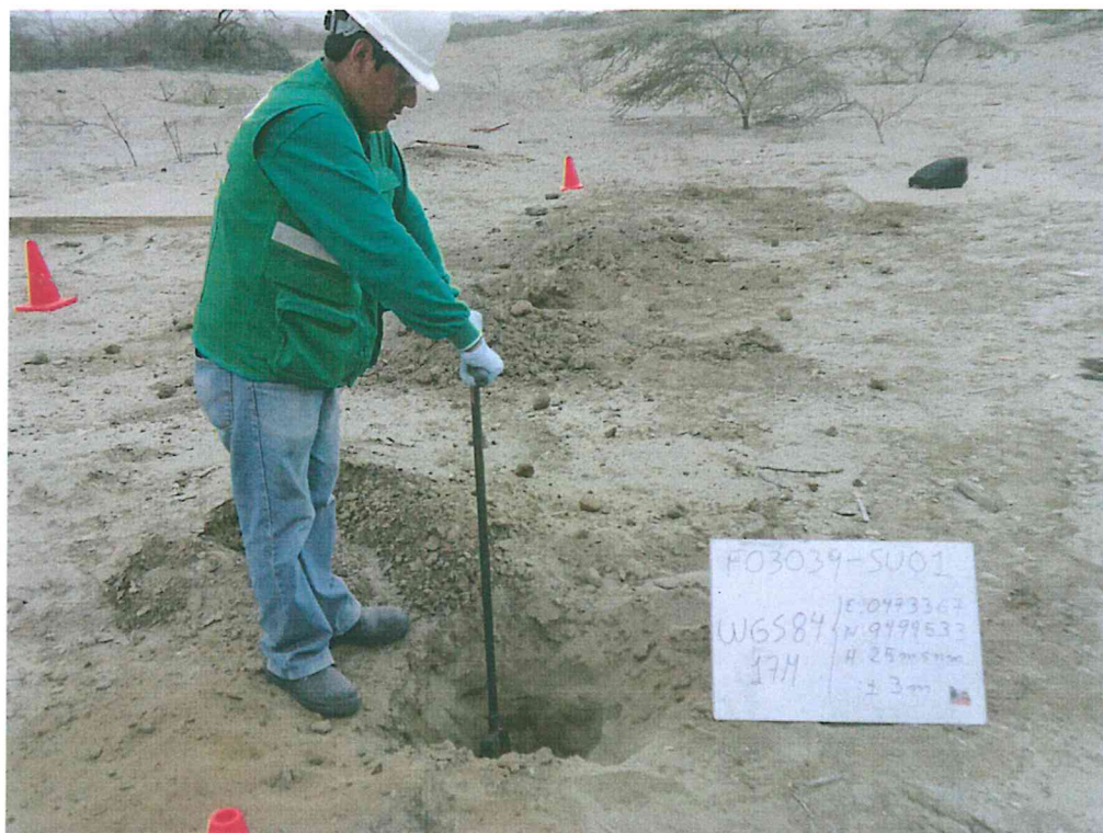
Fotografía N° 3. Toma de muestra de suelo en el punto F03039-SU01, ubicado aproximadamente a 4,5 m al noreste del Pozo T3375.
