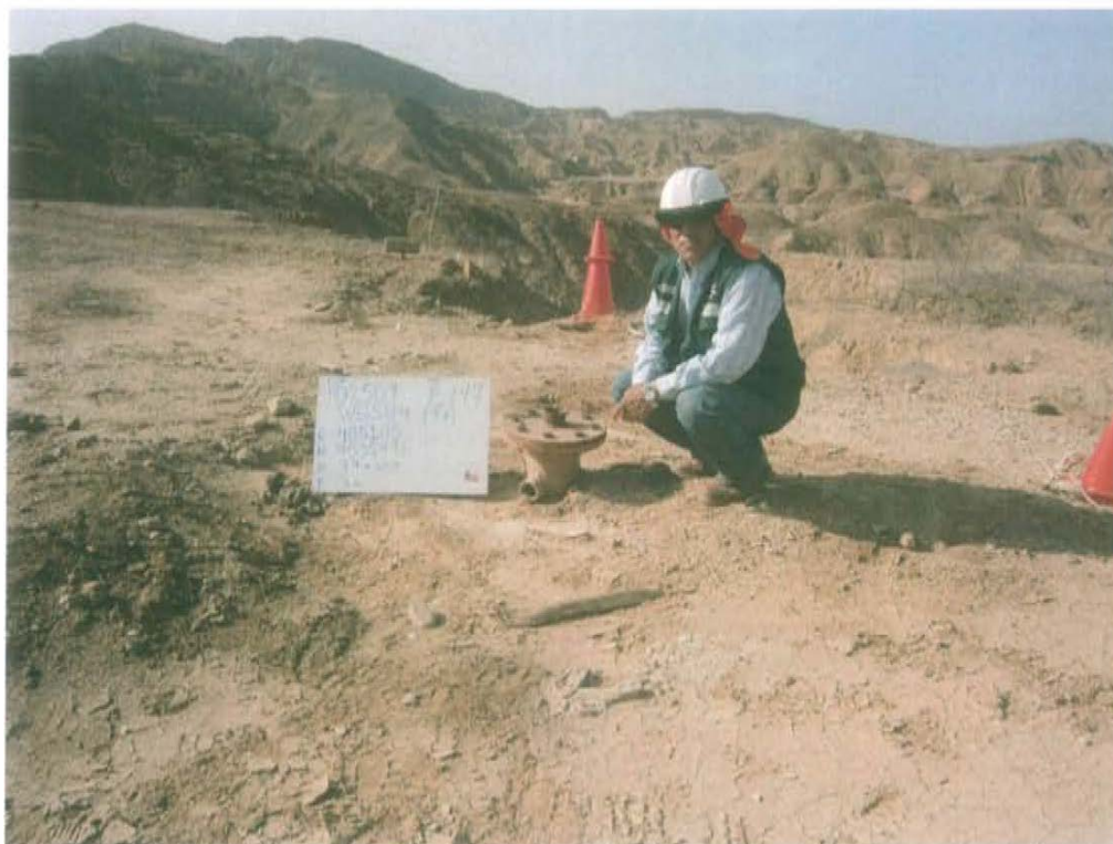
Fotografía N° 1. Identificación del pozo inactivo con código PERUPETRO P_147. Presenta casing con brida adaptadora y tubería con salida lateral sin dispositivos de cierre.
