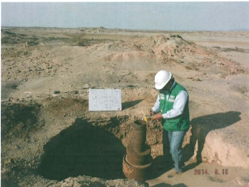
Fotografía N° 4. Medición en el punto F00416-EM01, ubicado en la fuente de emisión en boca del Pozo T1511.
