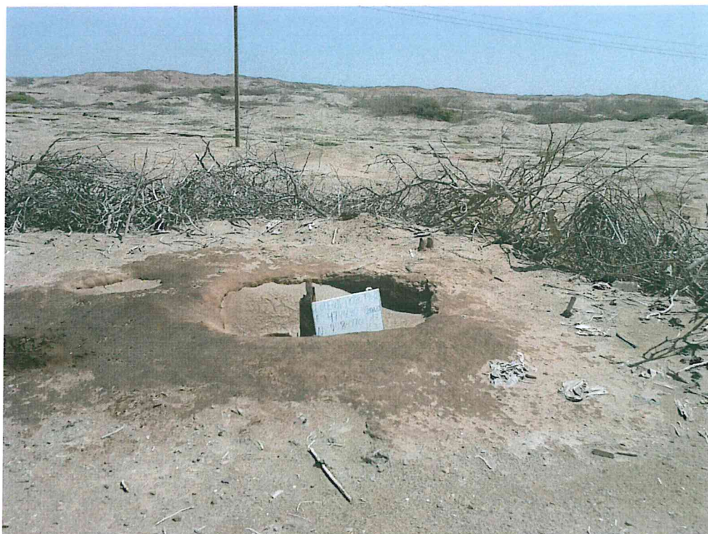
Fotografía N° 1. Pozo inactivo con código PERUPETRO T1612 donde se observa el casing sin brida y abierto al ambiente.
