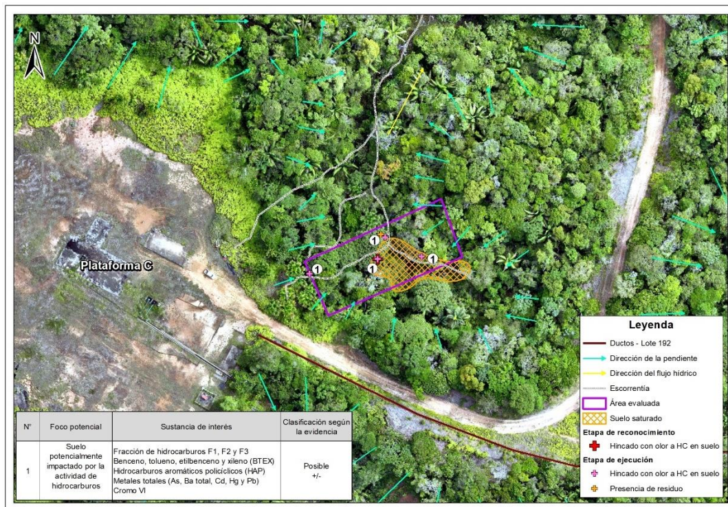
Figura 3.3. Focos potenciales de contaminación en el sitio S0269 HC: Hidrocarburo.
