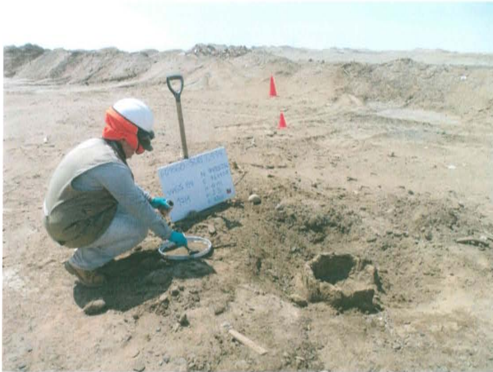
Fotografía N° 3. Toma de muestra de suelo en el punto F01560-SU01, ubicado a 0,5 m aproximadamente del Pozo T_414.
