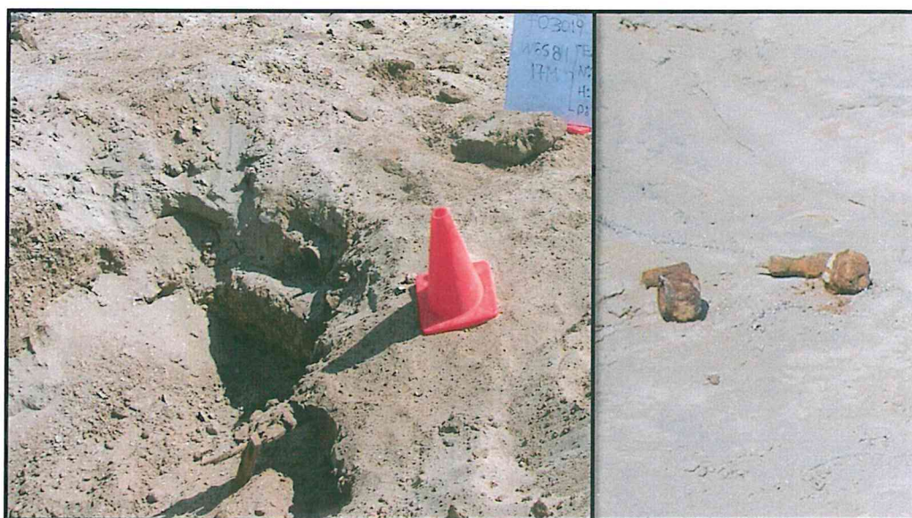
Fotografía N° 2. Se observan indicios de la existencia del pozo con código PERUPETRO T2898, como estructuras enterradas y restos metálicos.
