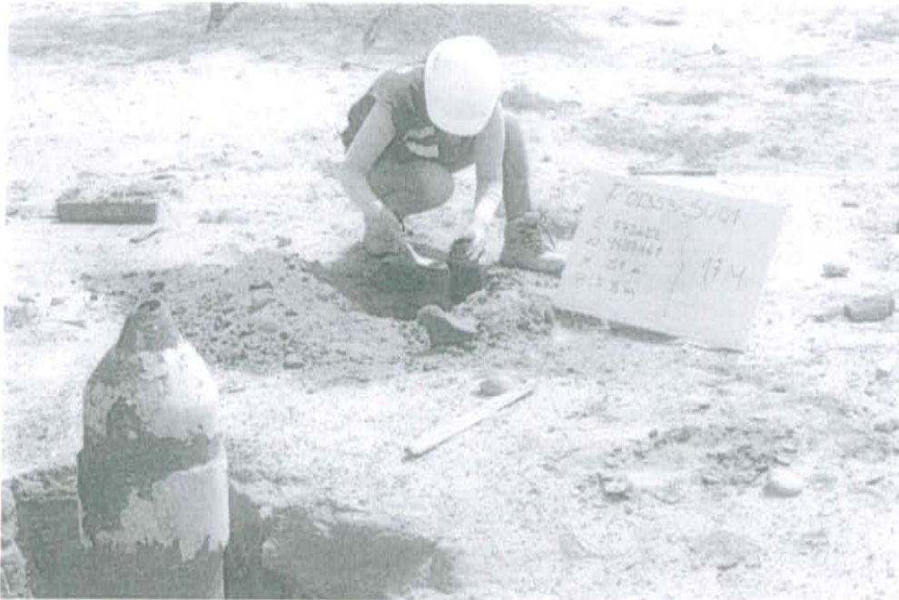
Fotografía N° 1. Toma de muestra en el punto F01353-SU01, ubicado a 2 m de distancia del casing del pozo T 1804 a una profundidad de 0,5 m de la superficie del suelo.
