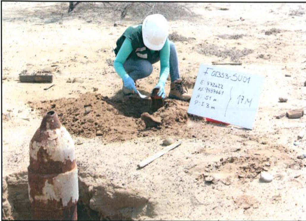
Fotografía N° 3. Toma de muestra en el punto F01353-SU01, ubicado a 2 m de distancia del casing del pozo T 1804.
