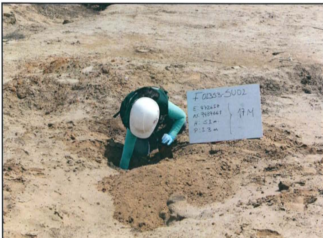
Fotografía N° 4. Toma de muestra en el punto F01353-SU02, ubicado a 5,8 m de distancia del casing del pozo T 1804.
