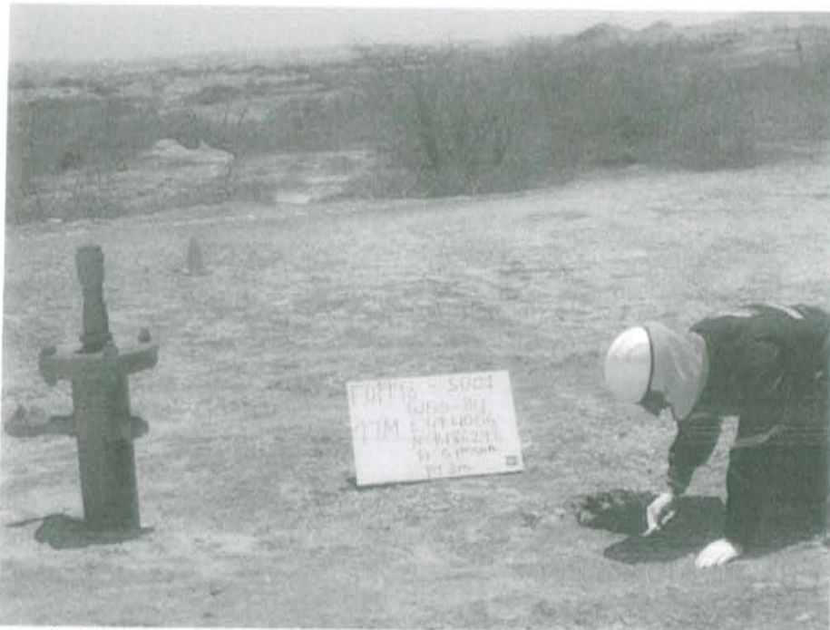
Fotografía N° 1. Toma de muestra de suelo en el punto F01998-SU01, ubicado a 1,5 m aproximadamente del Pozo T2931.
