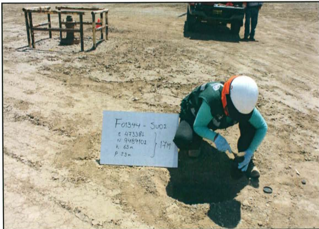
Fotografía N° 4. Toma de muestra en el punto F01344-SU02, ubicado a 5,1 m de distancia del casing del pozo T 2447 a una profundidad de 0,4 m de la superficie del suelo.
