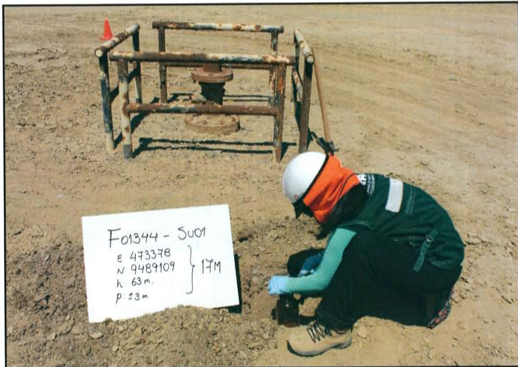
Fotografía N° 3. Toma de muestra en el punto F01344-SU01, ubicado a 2 m de distancia del casing del pozo T 2447 a una profundidad de 0,25 m de la superficie del suelo.
