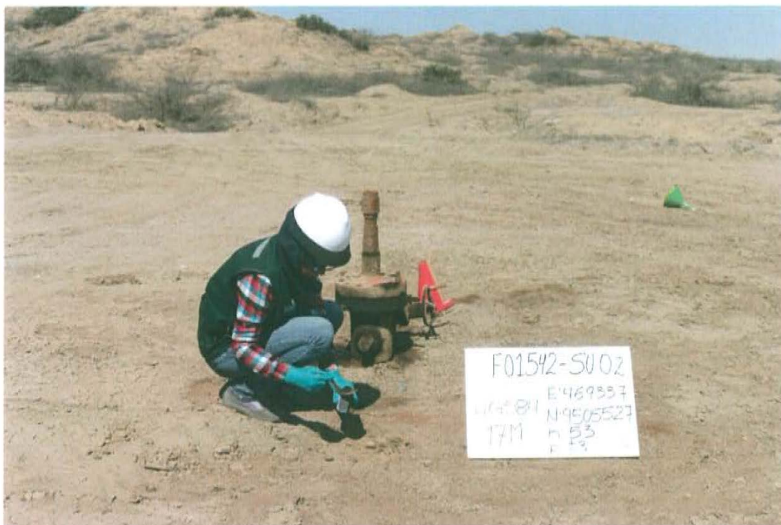
Fotografía N° 3. Toma de muestra de suelo en el punto F01542-SU02, ubicado aproximadamente a 1,22 m del Pozo L_532.
