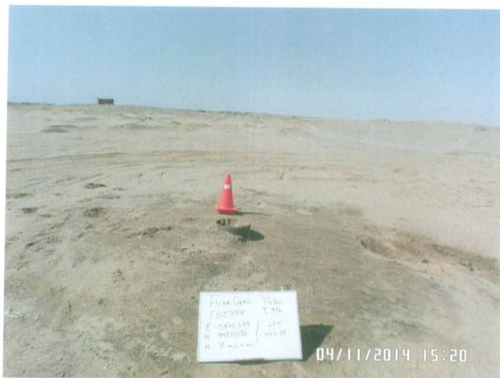
Fotografía N° 2. Vista panorámica del pozo T_986, ubicado en un relieve plano donde se observa suelo contaminado con hidrocarburos.
