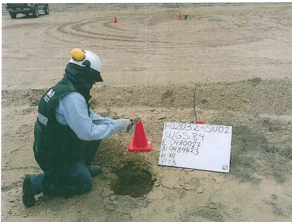
Fotografía N° 4. Toma de muestra de suelo en el punto F02032-SU02, ubicado a 11 m aproximadamente del Pozo T3172.
