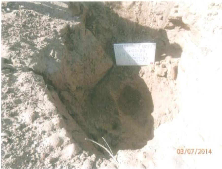
Fotografía N° 1 Pozo inactivo ubicado dentro de un hoyo de aproximadamente 1,4 m de profundidad.
