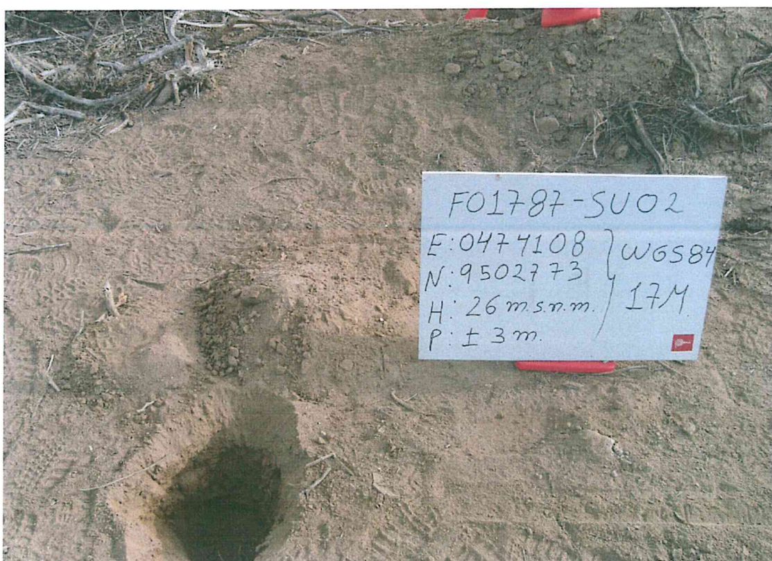
Fotografía N° 04.- Toma de muestra de suelo en el punto F01787-SU02, ubicado a 3 m aproximadamente del Pozo T3851.
