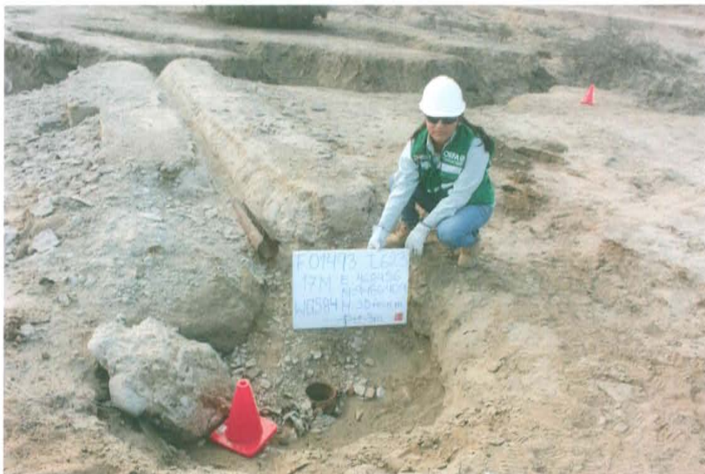
Fotografía N° 1. Pozo T_623, presenta casing abierto cerca de una base de concreto (posible base de la unidad de bombeo mecánico).
