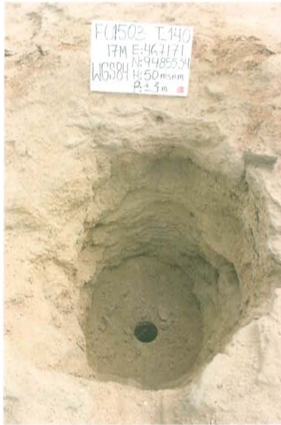
Fotografía N° 1. Pozo T_140, con casing al ras del suelo dentro de un hoyo.
