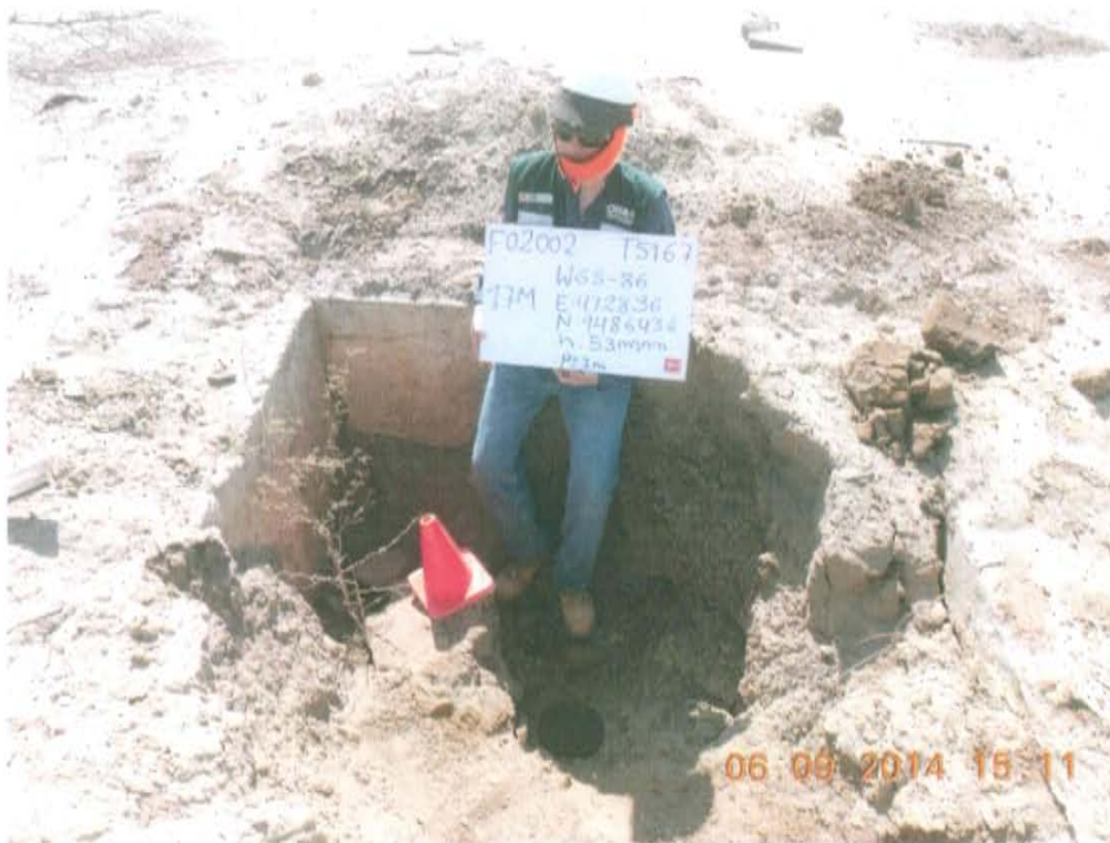
Fotografía N° 1. Identificación del pozo inactivo con código PERUPETRO T5167. Presenta casing cortado y abierto descubierto en el interior de una cantina deteriorada.
