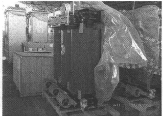
Fotografías N° 6 – Tecnología limpia de Transformadores secos encapsulados no usan aceite, propiedad de EDELNOR S.A.A. en el Almacén de NEPTUNIA
