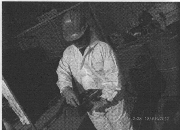
Fotografías N° 21 – Proceso de toma de muestras para análisis de Bifenilos Policlorados - PCBs, en aceites dieléctricos.
