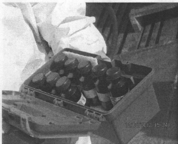
Fotografías N° 22 – Proceso de toma de muestras para análisis de Bifenilos Policlorados - PCBs, en aceites dieléctricos.
