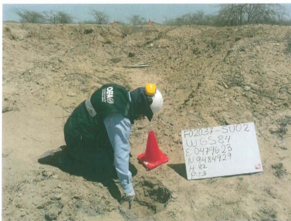
Fotografía N° 4. Toma de muestra de suelo en el punto F02037-SU02, ubicado a 15 m aproximadamente del Pozo T2924.
