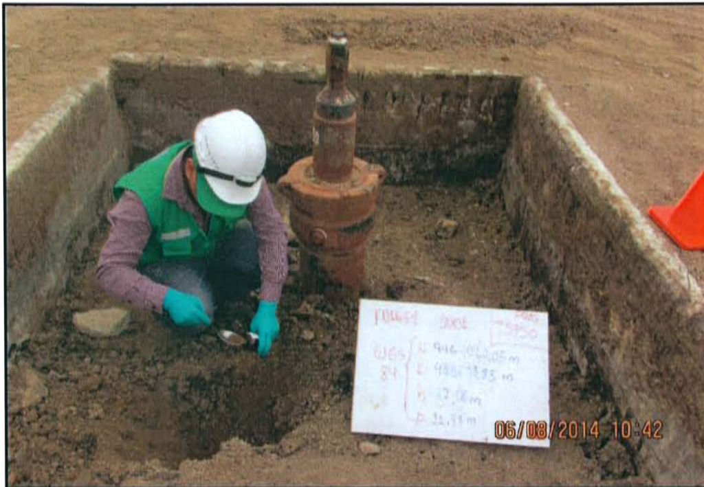
Fotografía N° 3. La muestra de suelo F01661-SU01 se tomó a 0,76 m de distancia del Pozo y a una profundidad de 0,35 m de la superficie del suelo.
