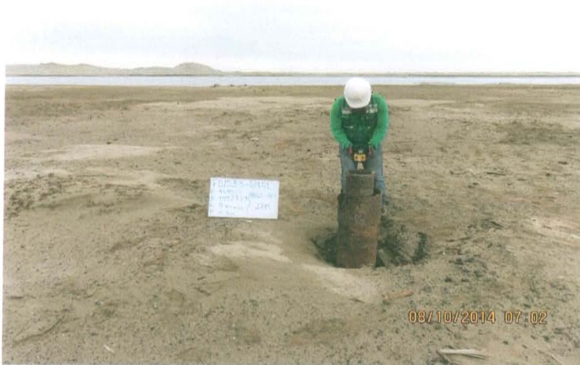
Fotografía N° 6. Medición de emisiones en el punto F01533-EM01, ubicado en la boca del pozo.
