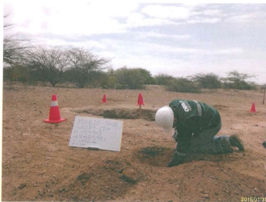
Fotografía N° 3. Toma de muestra de suelo en el punto F02810-SU01, ubicado a 3 m de distancia aproximadamente del Pozo T2021.
