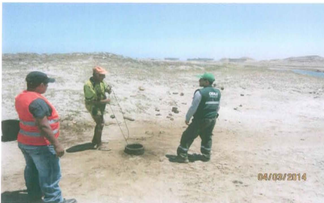
Fotografía N° 3. Vista de la extracción artesanal de hidrocarburos que se realiza en el área de ubicación del pozo T_609
