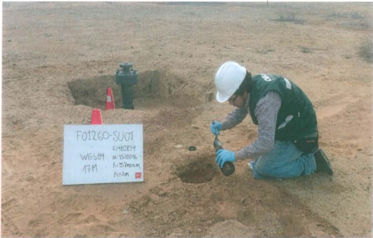
Fotografía N° 3. Toma de muestra de suelo en el punto F01260-SU01 ubicado a 3 m aproximadamente del pozo.
