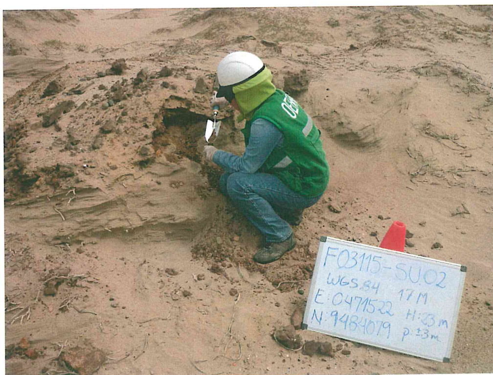
Fotografía N° 4. Toma de muestra de suelo en el punto F03115-SU02, ubicado aproximadamente a 4 m al noreste del Pozo T1585.
