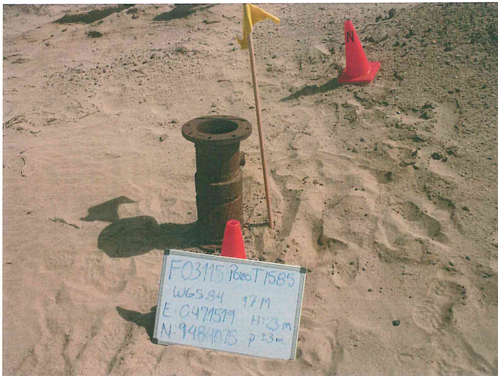
Fotografía N° 1. Identificación del pozo inactivo con código PERUPETRO T1585. Presenta casing con brida oxidada y corroída.
