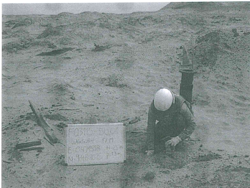
Fotografía N° 1. Toma de muestra de suelo en el punto F03115-SU01, ubicado a 2,2 m en dirección sur del Pozo T1585.
