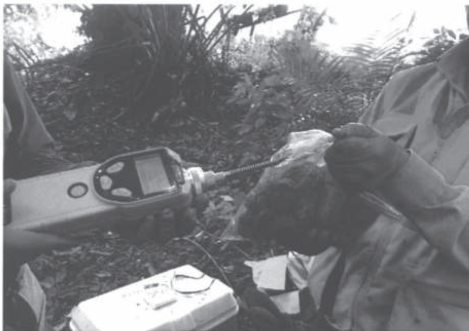
Fotografía 15. Lectura de PID para determinación de VOC's en el sondeo 008.
