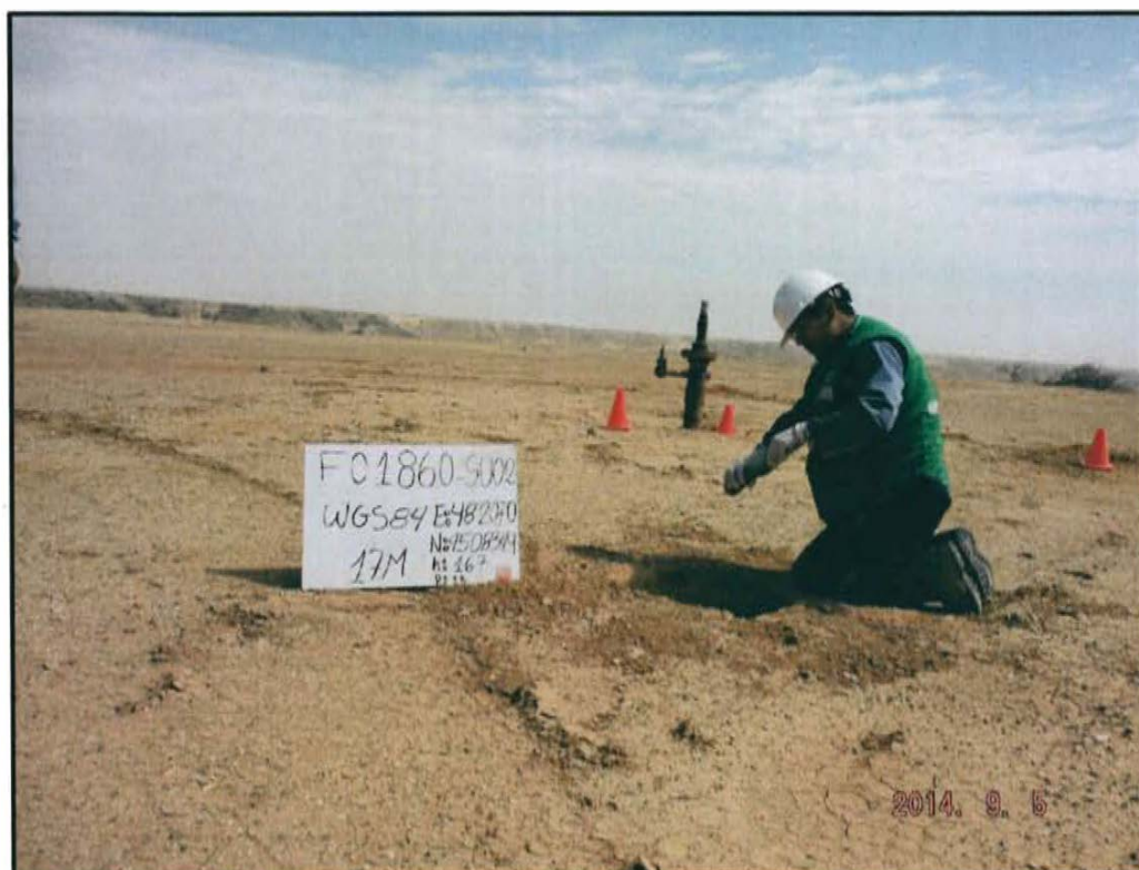
Fotografía N° 4. Muestra de suelo F01860-SU02 tomada a 6 m al norte del pozo.
