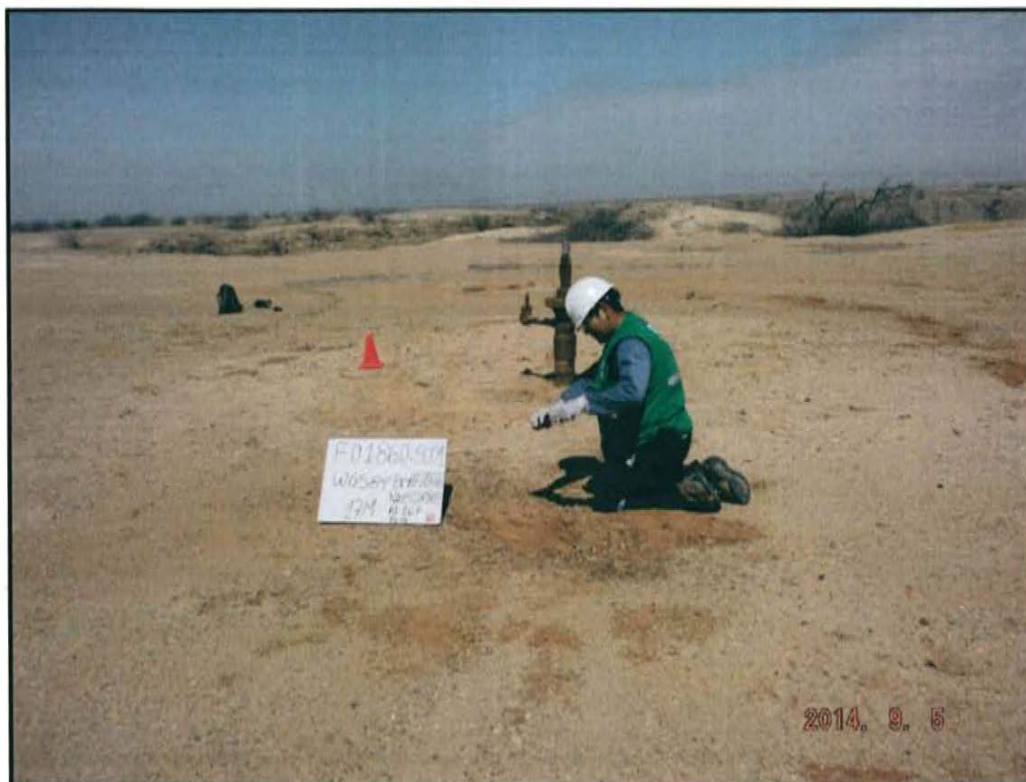
Fotografía N° 3. Muestra de suelo F01860-SU01 tomada a 3 m al oeste del pozo.
