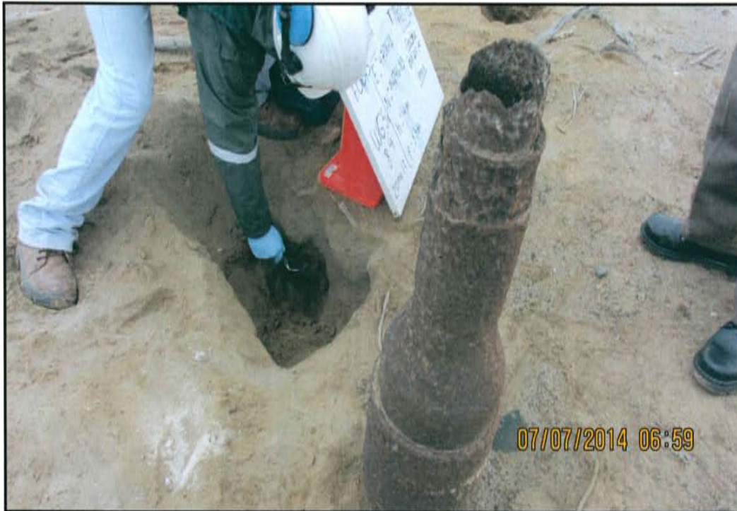
Fotografía N° 3. La muestra de suelo F01373-SU01 fue tomada a 0,5 m de distancia del casing del Pozo T1373.
