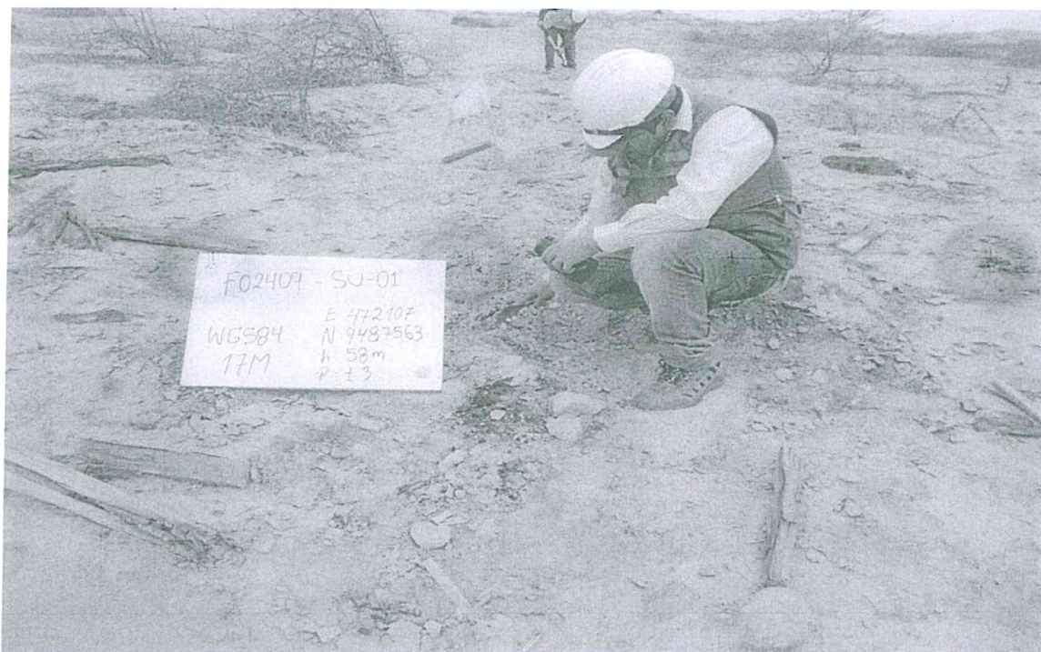
Fotografía N° 1. Toma de muestra de suelo en el punto F02409-SU01, ubicado a 4,1 m de la posible ubicación del casing del pozo.
