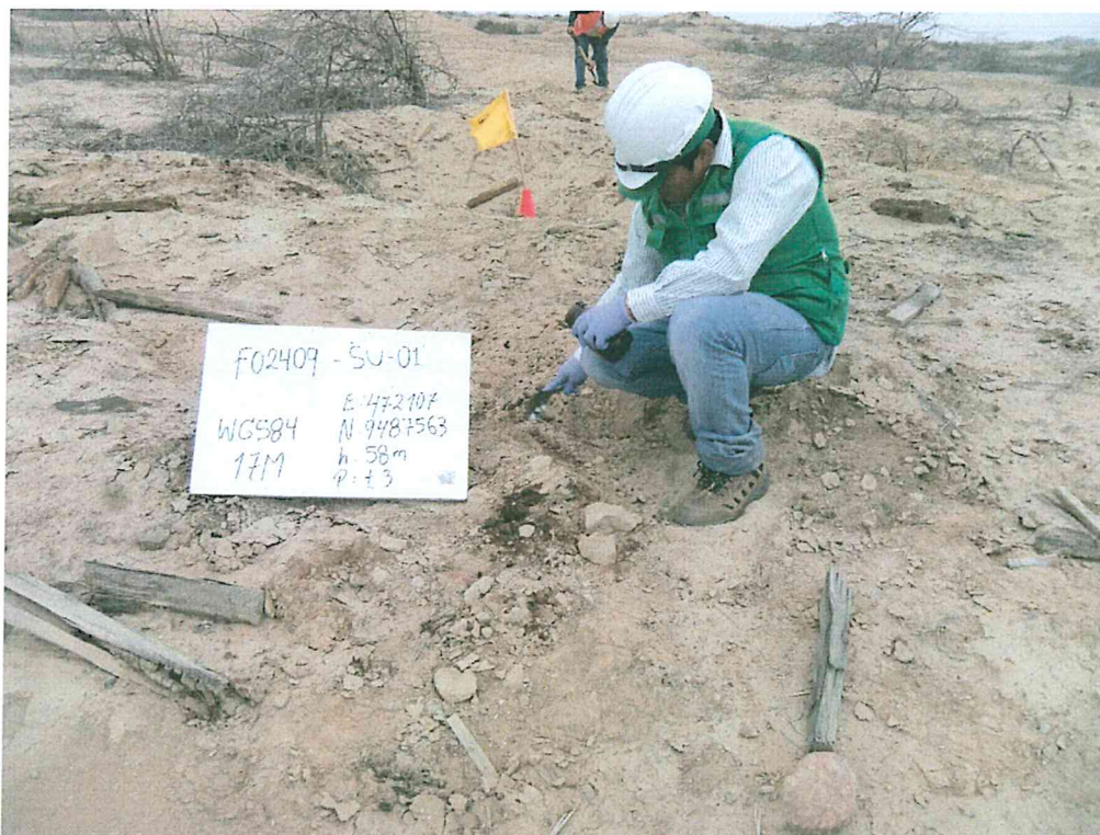
Fotografía N° 3. Toma de muestra de suelo en el punto F02409-SU01, ubicado a 4,1 m de la posible ubicación del casing del pozo.
