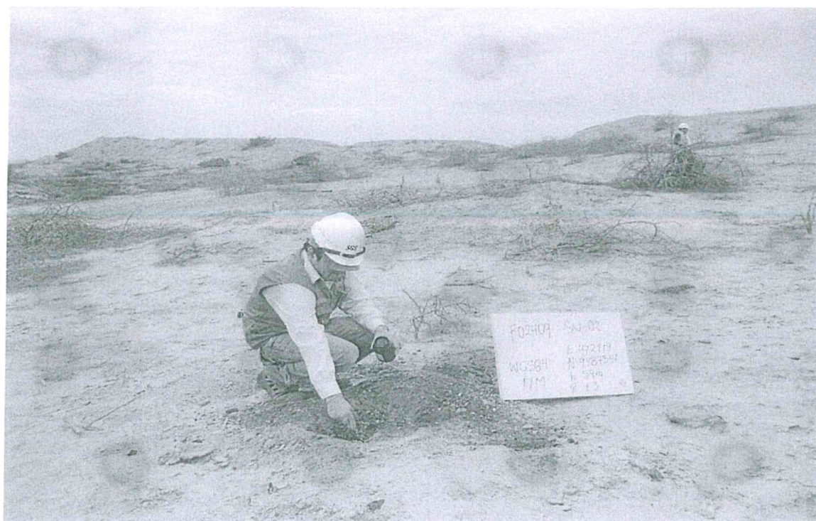
Fotografía N° 2. Toma de muestra de suelo en el punto F02409-SU02, ubicado a 9,3 m de la posible ubicación del casing del pozo.
