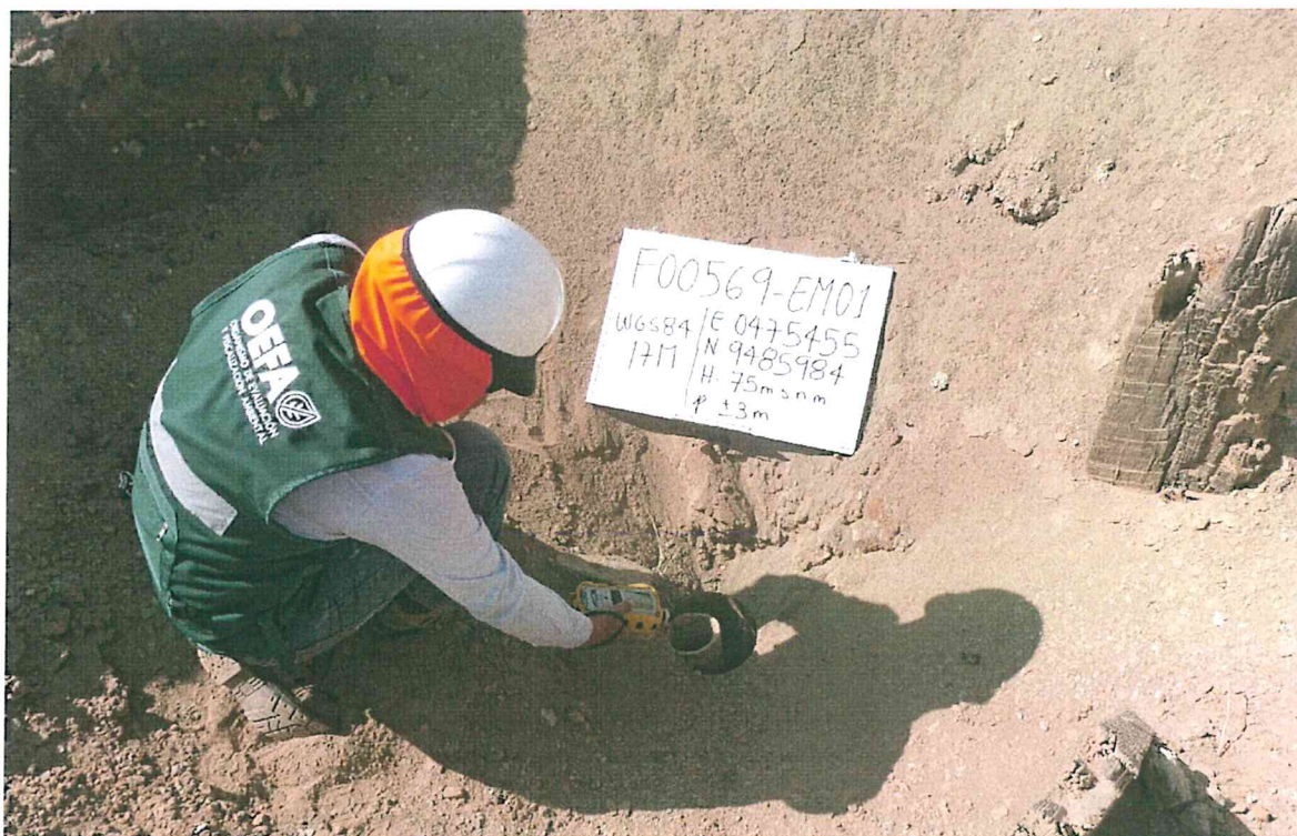
Fotografía N° 5. Medición en el punto F00569-EM01, ubicado en la fuente de emisión en boca del pozo T2639.
