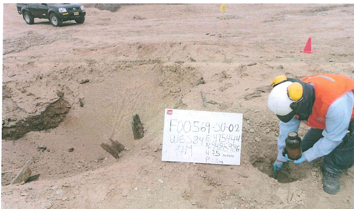
Fotografía N° 4. Toma de muestra de suelo en el punto F00569-SU02, ubicado a 3 m aproximadamente del pozo T2639.
