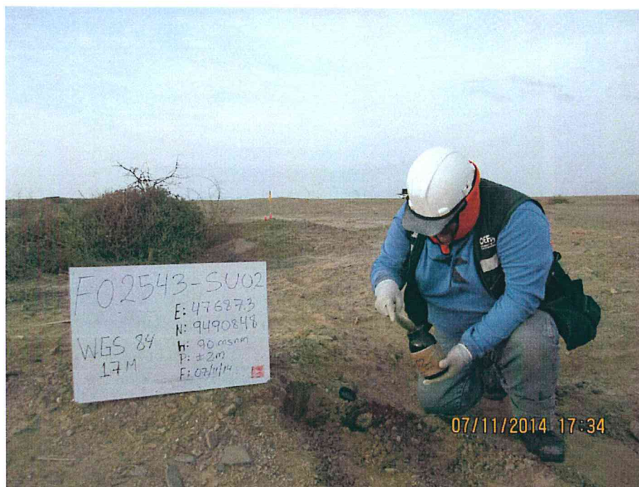
Fotografía N° 4. Toma de muestra de suelo en el punto F02543-SU02, ubicado a 8 m aproximadamente al sureste de la posible ubicación del pozo T3445.
