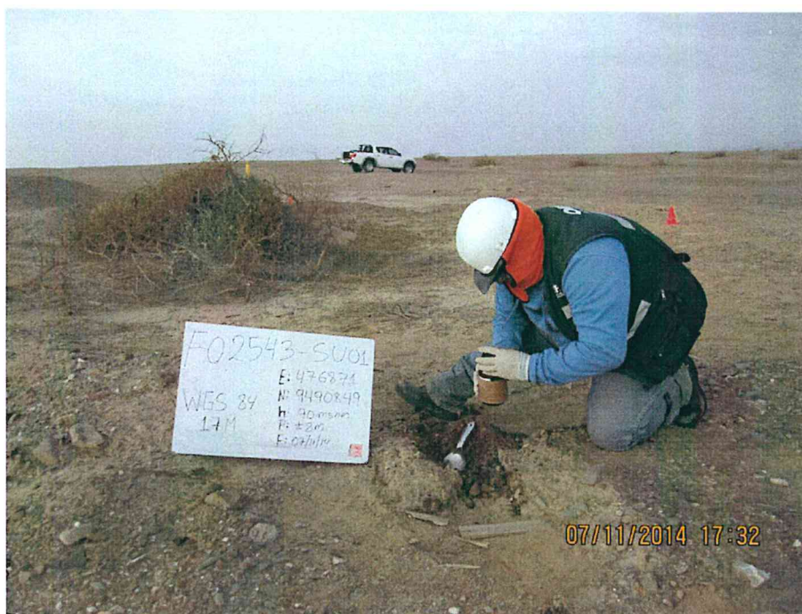
Fotografía N° 3. Toma de muestra de suelo en el punto F02543-SU01, ubicado a 6 m aproximadamente al sur de la posible ubicación del pozo T3445.
