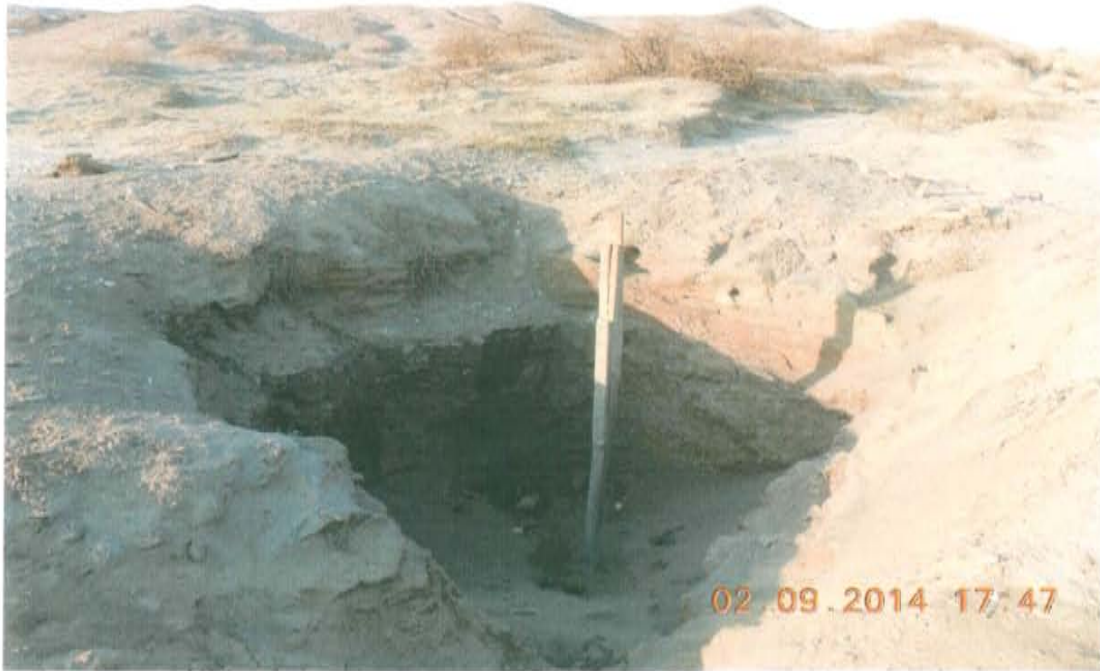
Fotografía N° 1. Identificación del pozo inactivo con código PERUPETRO T2726. Presenta casing cortado y abierto descubierto en el interior de una excavación de sección rectangular.
