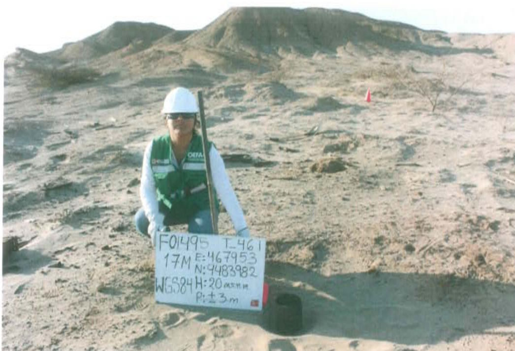
Fotografía N° 1. Pozo con código PERUPETRO T_461 y código Ficha OEFA F01495, se observa casing cortado y corroído, sin cabezal o algún elemento de cierre por lo que se encuentra abierto al ambiente.
