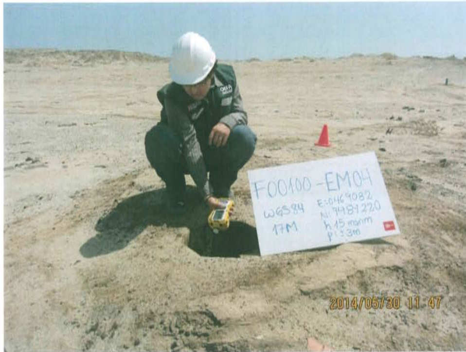
Fotografía N° 5. Medición de emisiones gaseosas fugitivas en boca de pozo.
