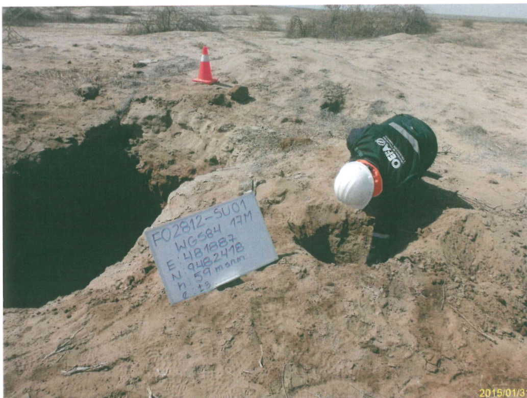
Fotografía N° 3. Toma de muestra de suelo en el punto F02812-SU01, ubicado a 2 m aproximadamente del Pozo T4298.
