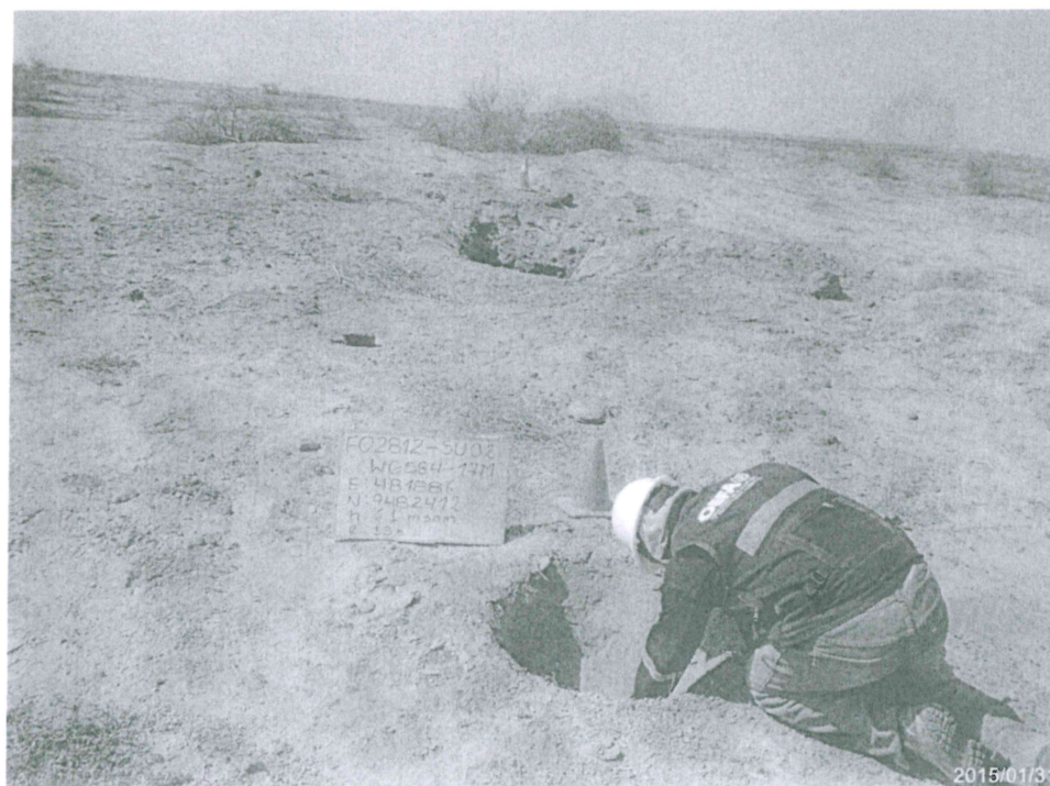
Fotografía N° 2. Toma de muestra de suelo en el punto F02812-SU02, ubicado a 6 m aproximadamente del Pozo T4298.
