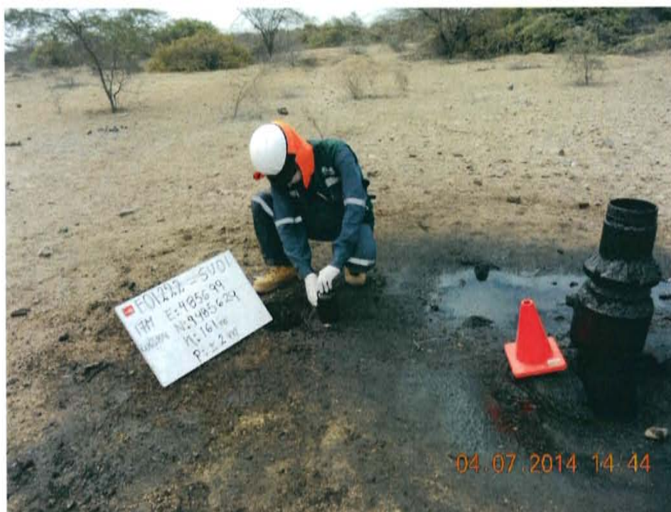
Fotografía N° 3. Toma de muestras de suelo en el punto F01222-SU01 ubicado a 1,45 m del pozo, donde se visualiza suelo con coloración oscura.
