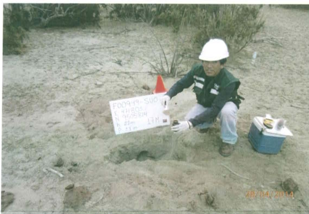
Fotografía N° 4. Vista del recojo de la muestra de suelo realizado por el evaluador en el área de ubicación del pozo en el punto F00949-SU02.
