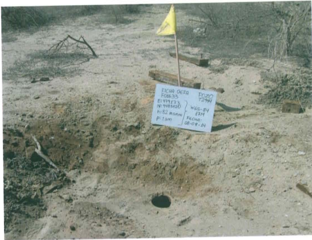
Fotografía N° 1. Pozo inactivo con código PERUPETRO T2944. Se observa casing al nivel de la superficie del suelo.
