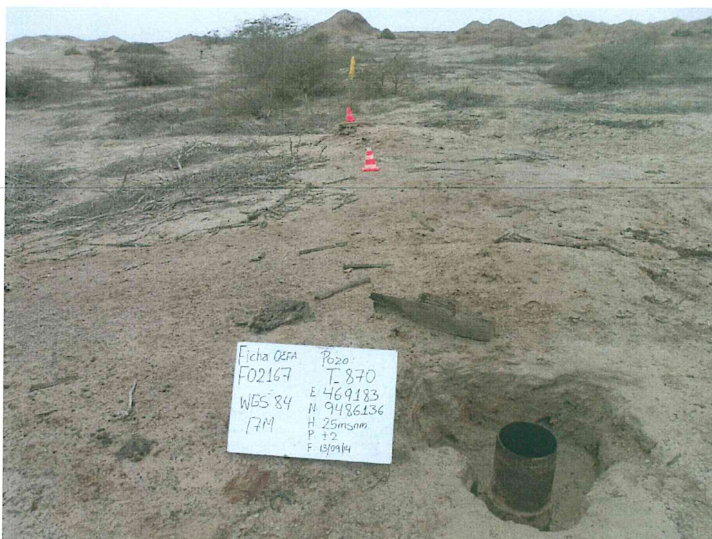
Fotografía N° 1. Se observa casing corroído que sobresale del interior de un hoyo y se encuentra abierto al ambiente.
