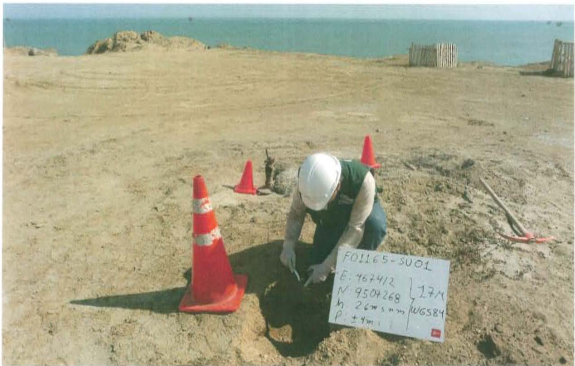
Fotografía N° 03.- Toma de muestra de suelo en el punto F01165-SU01, ubicado a 3,8 m aproximadamente del Pozo L_155.
