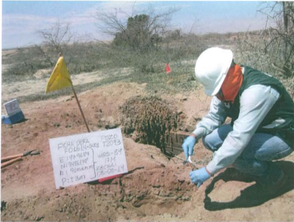
Fotografía N° 3. Toma de muestra de suelo en el punto F01614-SU01, ubicado a 2,2 m del Pozo T2093.
