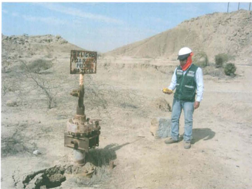
Fotografía N° 6. Mediciones en el punto F01916-VA01, se realizó un recorrido en el área circundante alrededor del pozo T4010, en un radio de 1 m aproximadamente y con una duración de 10 minutos.
