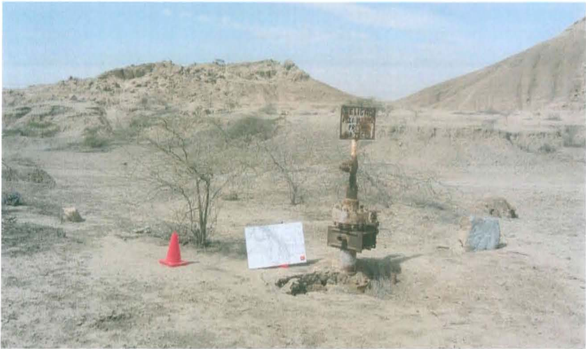
Fotografía N° 1. Pozo con código PERUPETRO T4010 y código Ficha OEFA F01916, se observa el cabezal compuesto por unas bridas y un arreglo de tuberías reductoras, algunas sin válvula de cierre por lo que se encontrarían expuestos al ambiente.
