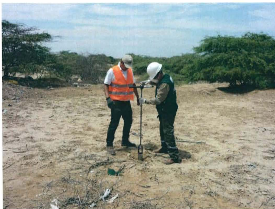
Fotografía N° 3. Recorrido exploratorio utilizando el barreno para la extracción de suelos a diferentes profundidades.
