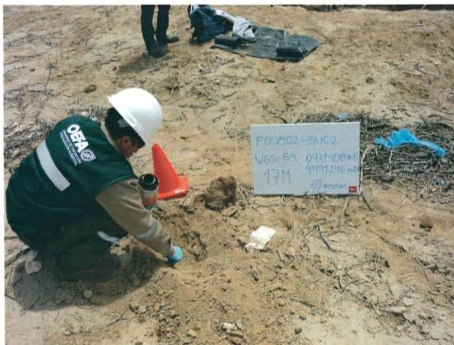
Fotografía N° 4. Recojo de muestra de suelos, en zonas con posible presencia de hidrocarburos.
