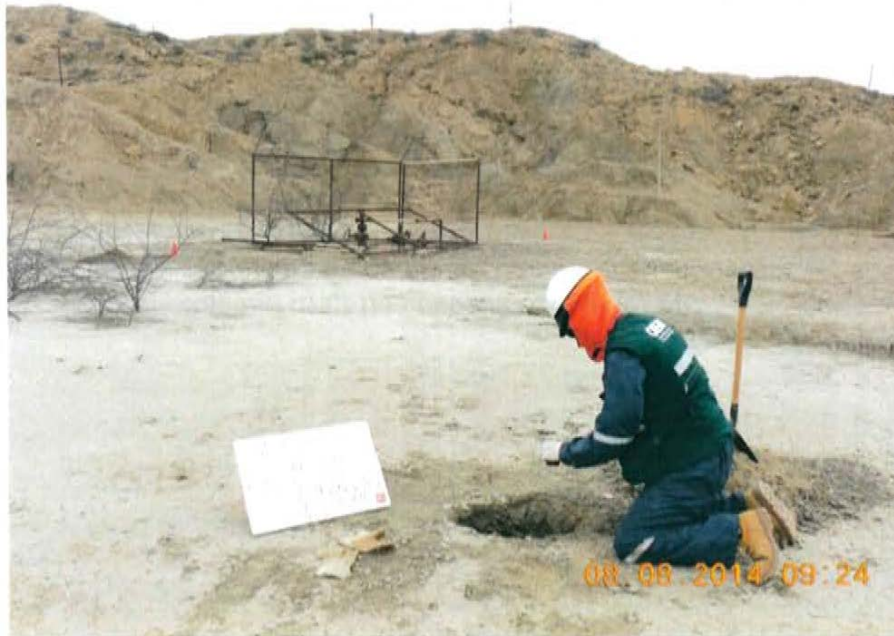
Fotografía N° 3. Toma de muestras de suelo en el punto F01754-SU02 a 17 m del cabezal del pozo T4970.
