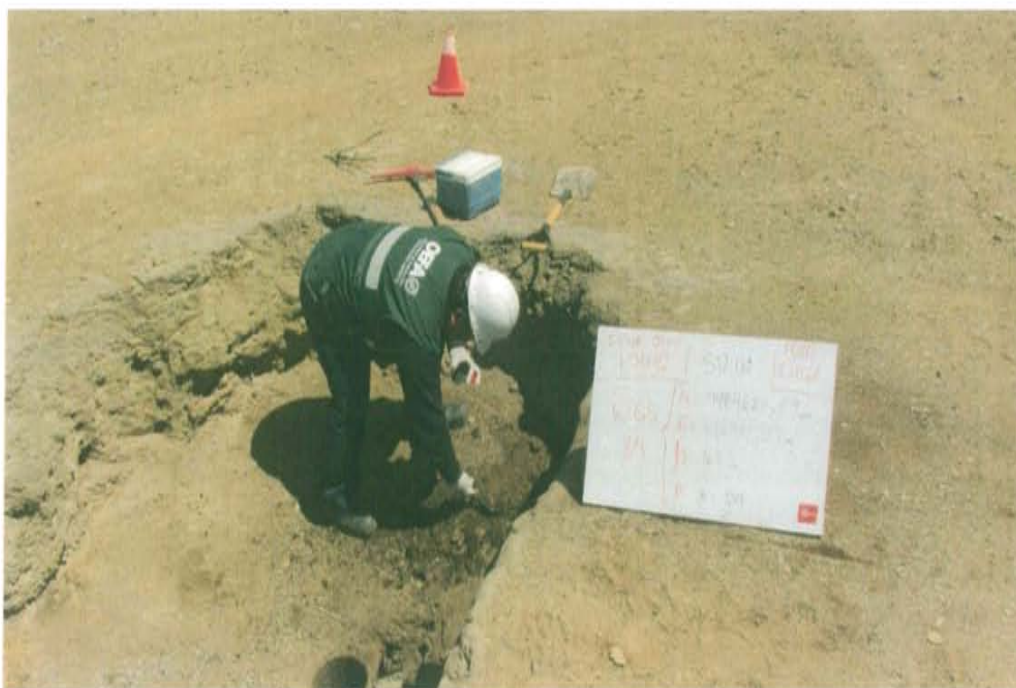
Fotografía N° 2. Toma de muestra de suelo en el punto F01672-SU01, ubicado a 1 m del pozo.
