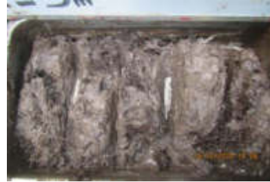
Suelo Mojado que presenta una textura predominantemente arcillosa.
