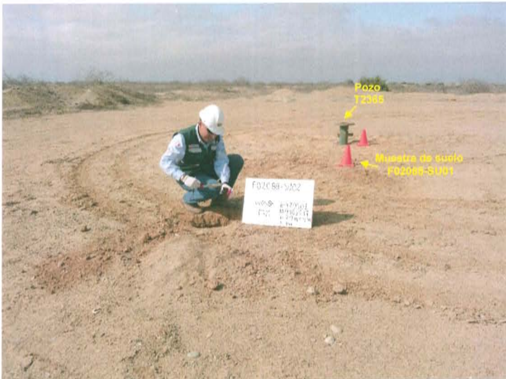
Fotografía N° 4. Toma de muestra de suelo en el punto F02088-SU02, ubicado a 5 m aproximadamente del Pozo T2365.
