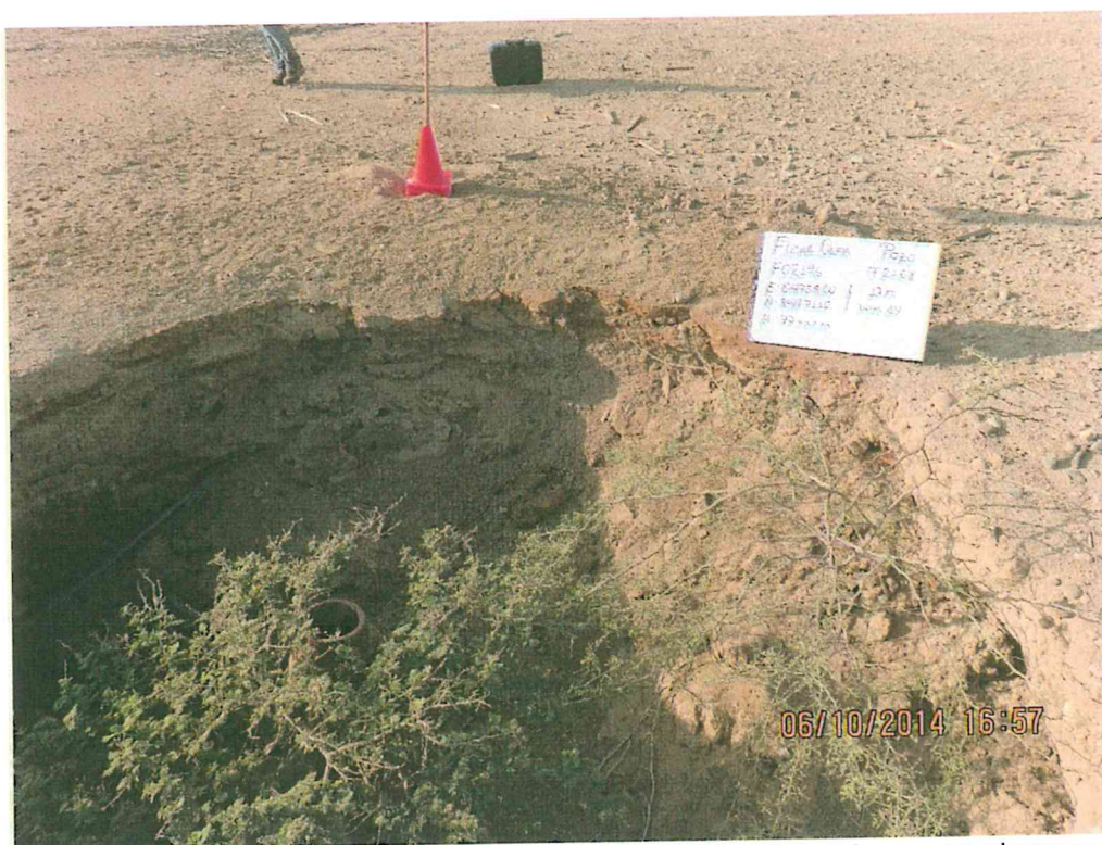
Fotografía N° 1. Vista pozo T2168 ubicado dentro de un hoyo, se observa el casing abierto al ambiente.
